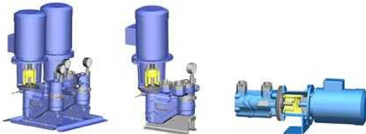
Винтовые насосы серии ALLFUEL AFM от компании Allweiler представляют собой компактные самовсасывающие агрегаты с тремя винтами (один приводной и два холостых для уплотнения) со встроенной магнитной муфтой, обеспечивающей полную герметизацию рабочей установки и приводного узла. Они широко используются в качестве инструментов подачи, циркуляции и слива расходных смазочных, гидравлических или горючих материалов для различных производственных механизмов и агрегатов.
