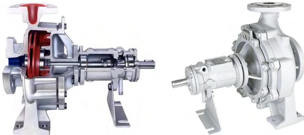
Одноканальные вихревые насосы серии NTT от компании Allweiler имеют практичную модульную конструкцию и предназначены для монтажа приводной установки опорной плите (из чугуна или стали), стандарт DIN EN 733. Идеальное решение для перекачки высокотемпературных масел в различных отраслях промышленности.
